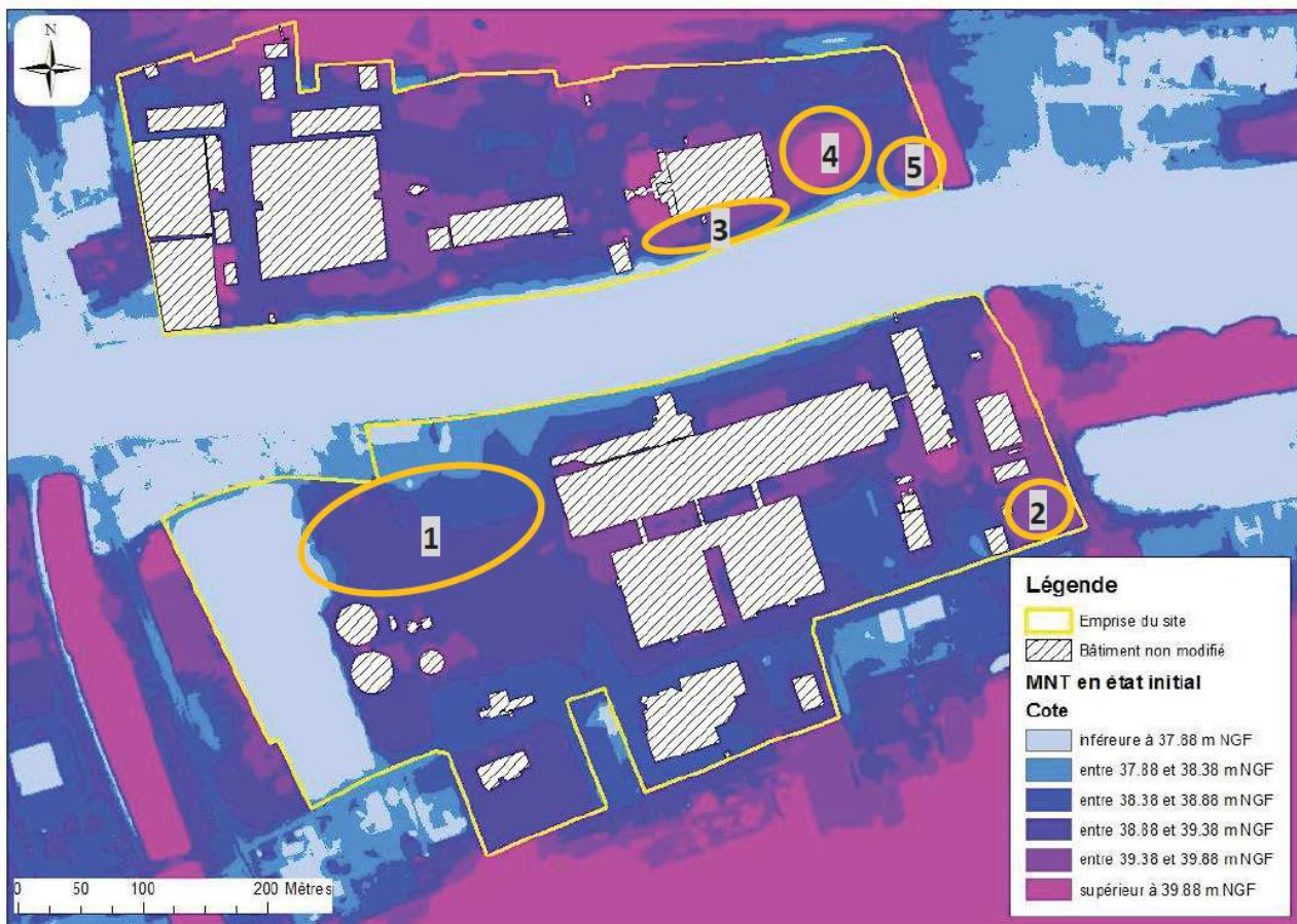
Figure 28 : MNT du site en état initial découpé par tranche altimétrique de 50 cm avec localisation des zones potentielles de compensation
